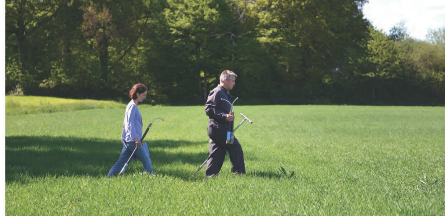
Pose de bougies poreuses destinées à mesurer la concentration en nitrates de l'eau. Cette expérimentation vise à identifier des liens entre pratiques agricoles et qualité de l'eau.
